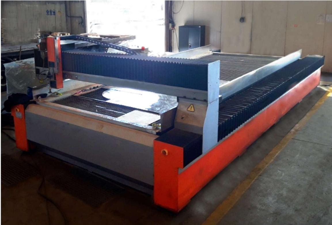
Wir bieten Wasserstrahlschneiden an. Die Wasserstrahltechnologie besteht aus dem Schneiden von Materialien mit einem Hochdruckwasserstrahl. Wasser enthält einen Strahlmittel, mit denen Stahl geschnitten werden kann.
